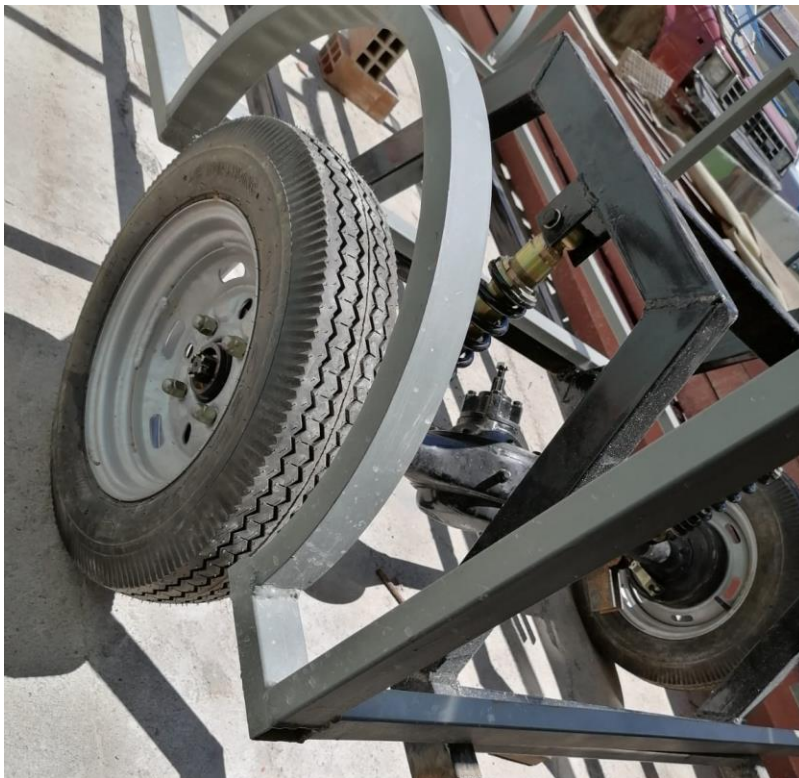
Figura 29 Ensamblaje de la carrocería con el chasis y el sistema de suspensión
