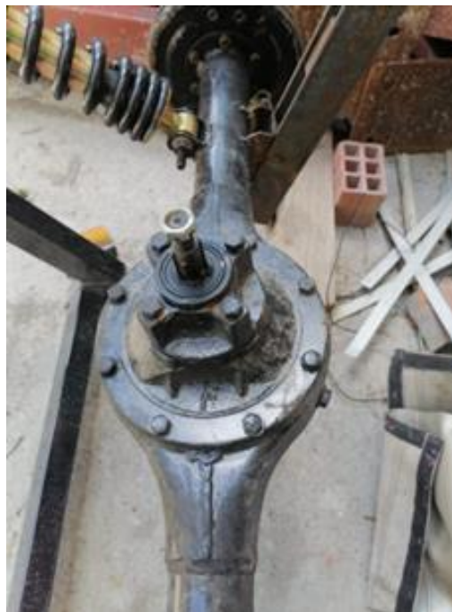
Figura 10 Transmisión por diferencial mecánico
