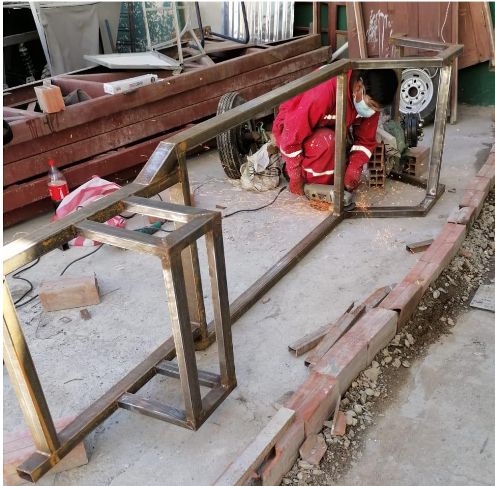
Figura 23 Amolado de la soldadura para darle una segunda pasada de reforzamiento en el chasis
