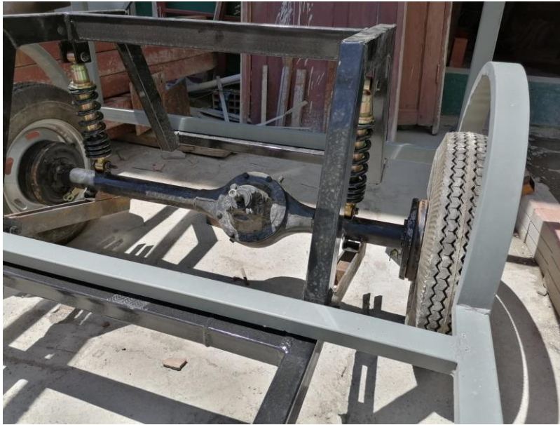
Figura 28 Ensamblaje de la carrocería con el chasis y el sistema de suspensión
