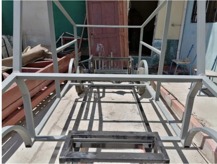
Figura 30 Interior del ensamblaje de la carrocería y el chasis
