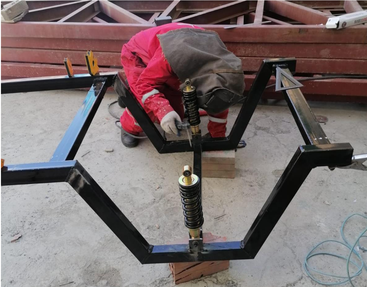
Figura 26 Ensamblado de los amortiguadores al chasis por medio de pernos con grado G-9
