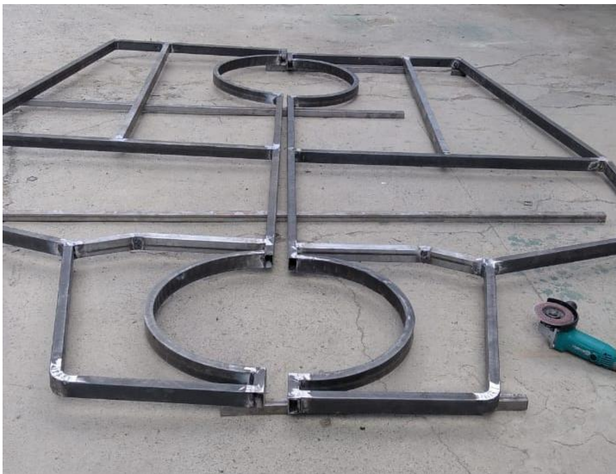
Figura 24 Laterales de la carrocería soldada con electrodos A.S.M.E. E 6013
