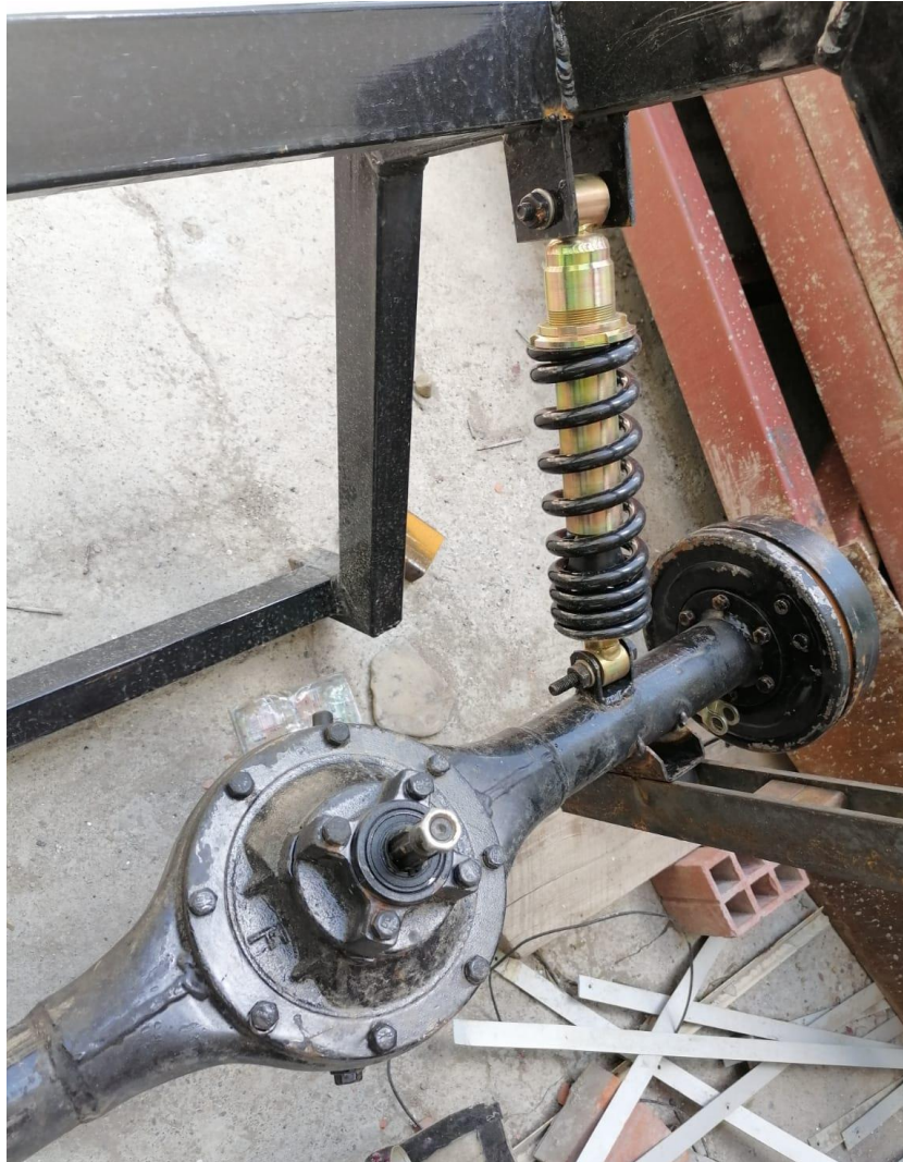
Figura 27 Ensamblado de los amortiguadores al diferencial
