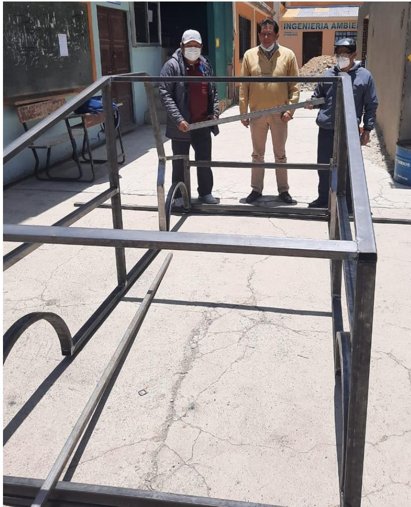
Figura 25 Carrocería completamente ensamblada, soldada con electrodos A.S.M.E. E 6013
