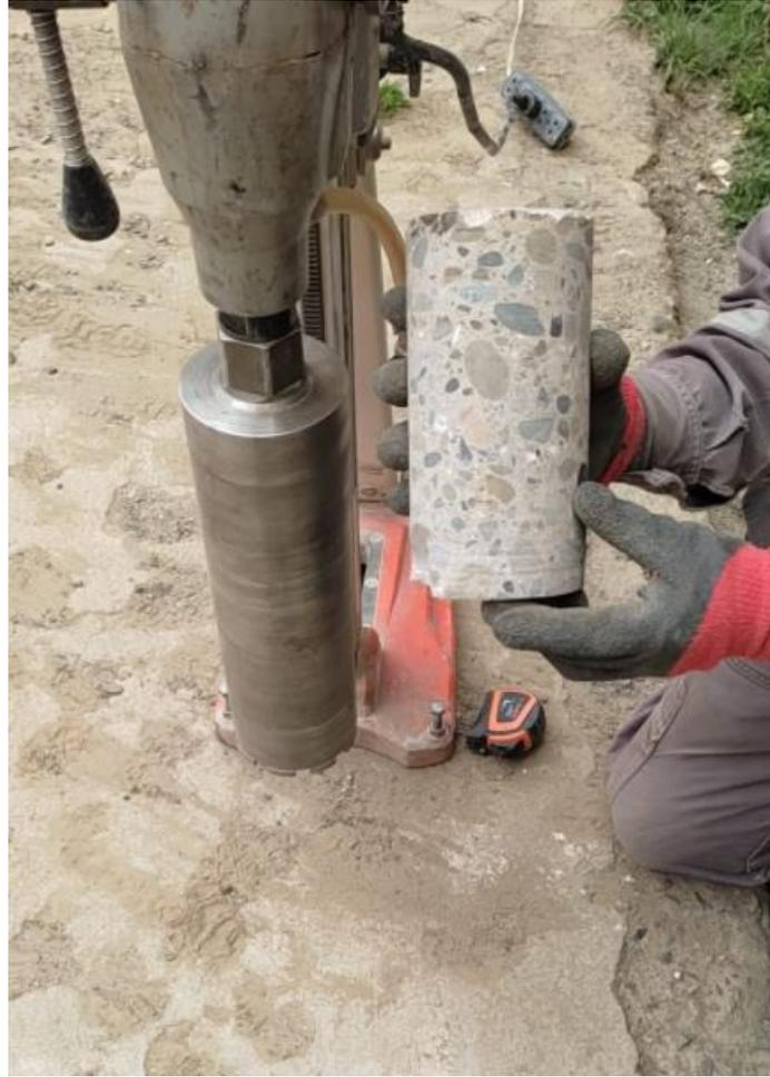
*Figura Nro 24. Muestra extraída con diamantina*
