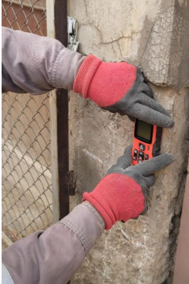
*Figura Nro 13. Ensayo de pacometría*
