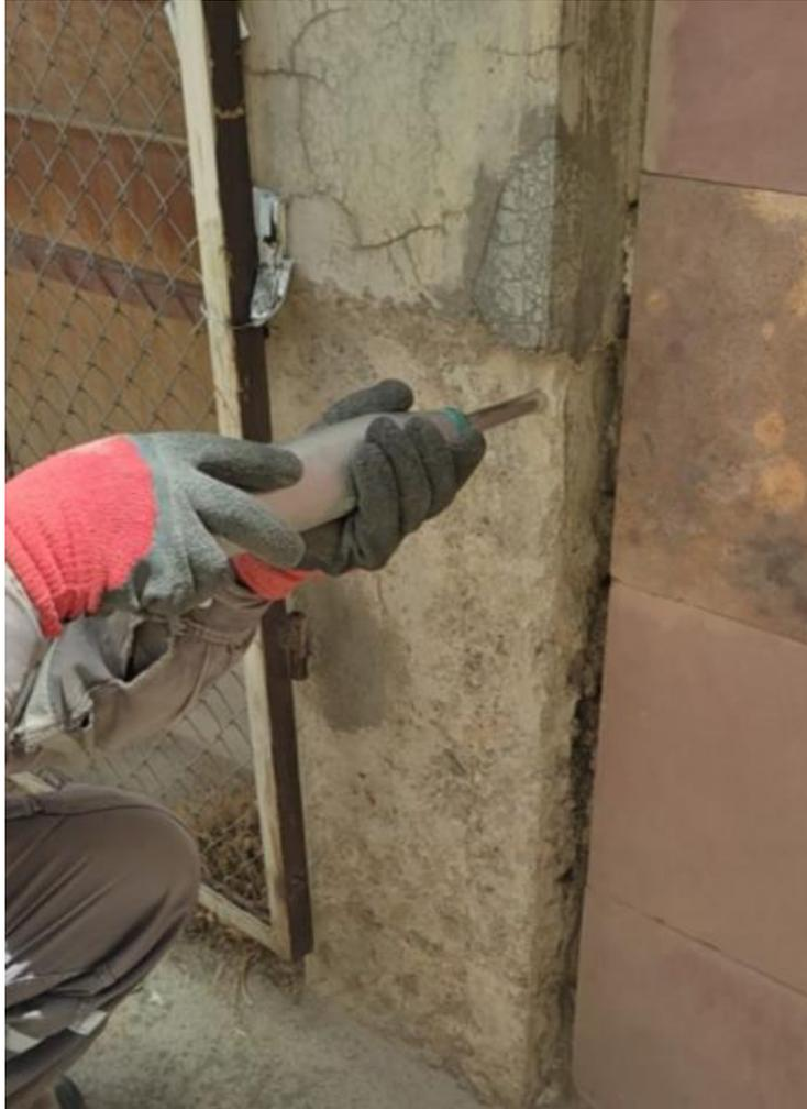
*Figura Nro 19. Ensayo de martillo neumático*
