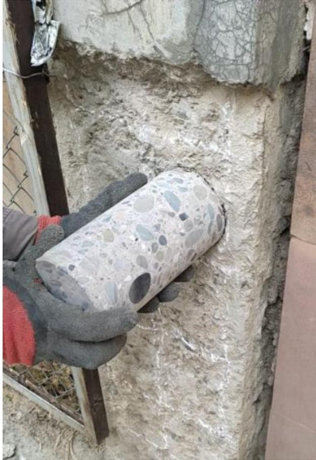
*Figura Nro 23. Extracción de testigos*
