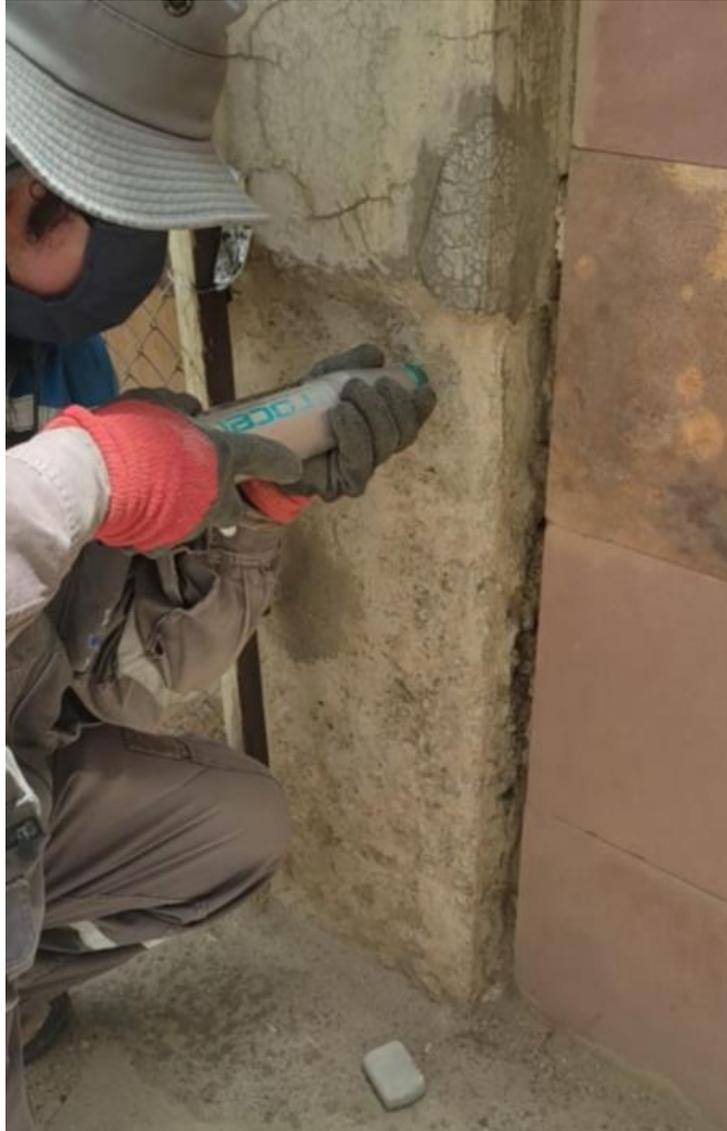
*Figura Nro 20. Esclerometría de columnas*
