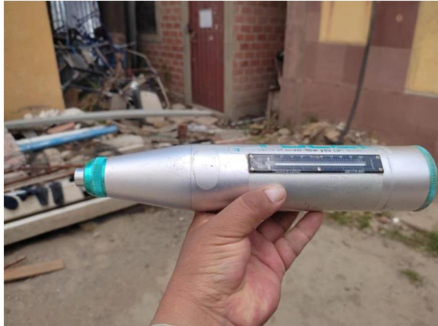
*Figura Nro 17 Esclerómetro digital*
