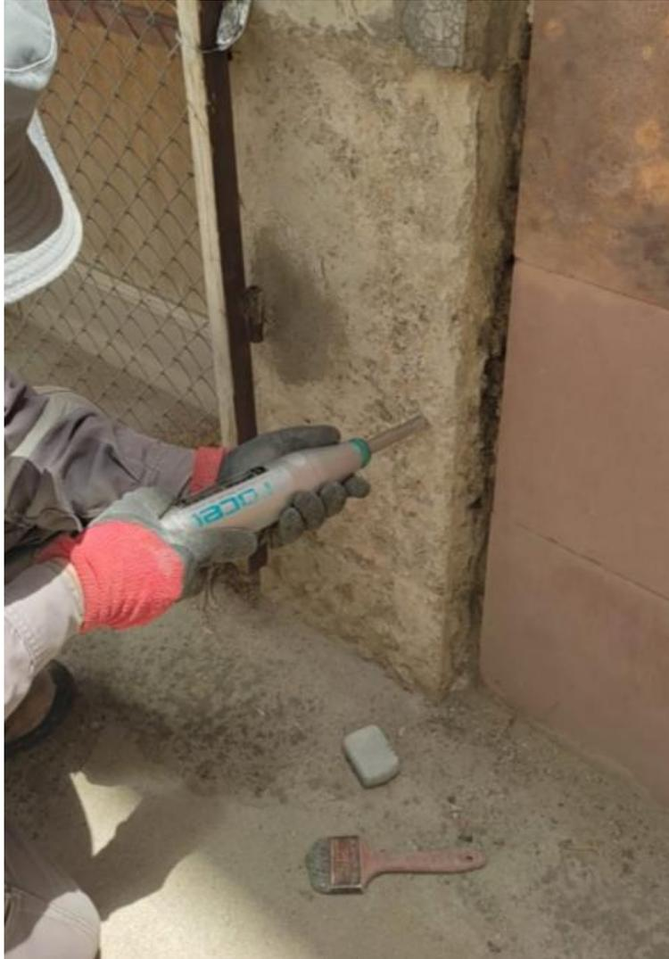
*Figura Nro 21. Ensayo con martillo nemático en columnas*
