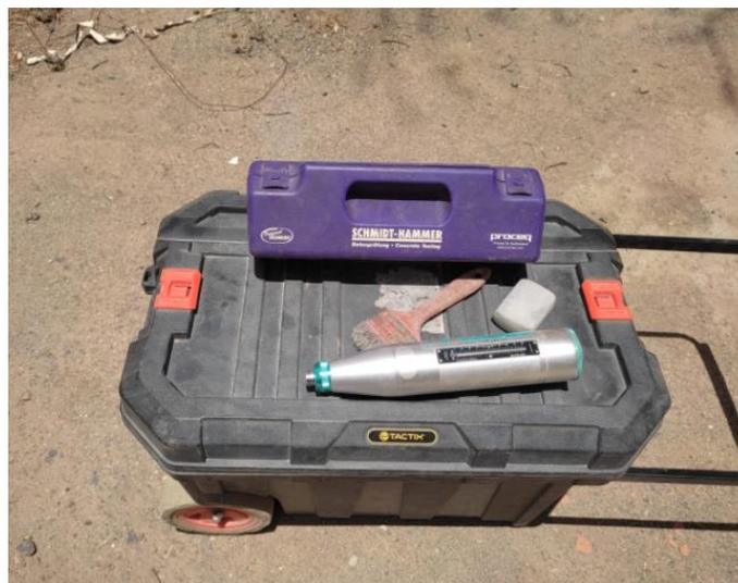
Figura Nro 16. Equipo de esclerometría
