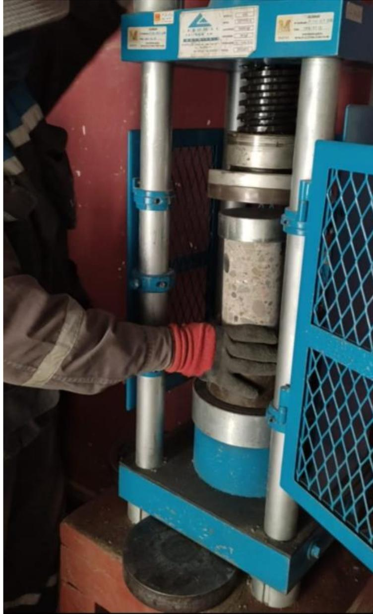
*Figura Nro 26. Ensayo de compresión de cilindros*
