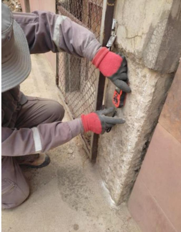
*Figura Nro 12. Preparación de la superficie para el ensayo esclerométrico*
