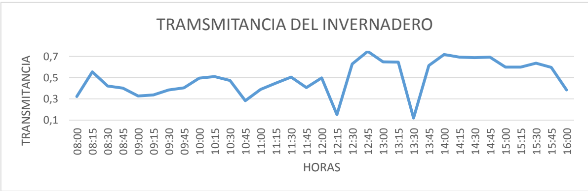
Grafica 4.1. En esta grafica se muestra la transmitancia experimental con un valor de 0.49 y con desviación estándar de 0.16, para el invernadero de carpa blanca.
