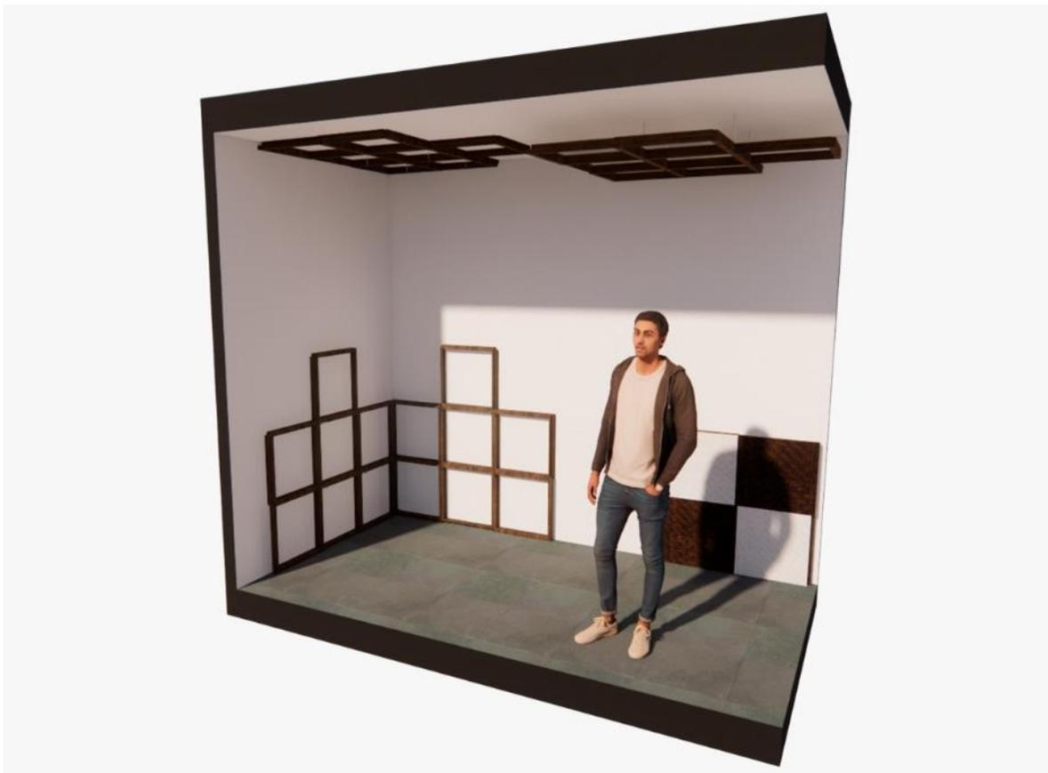
Figura 17. Imagen de implementación del eco-panel en muros y techo. Fuente: elaboración propia
