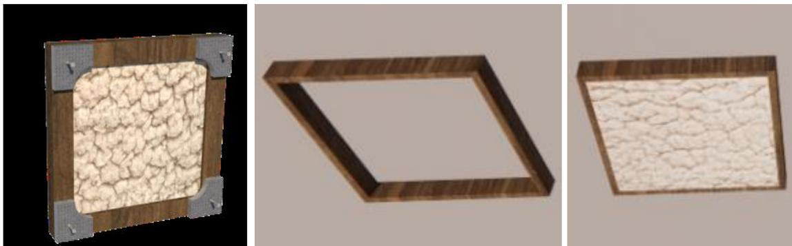
Figura 14. Relleno de la lana en los eco-panels. Fuente: elaboración propia
