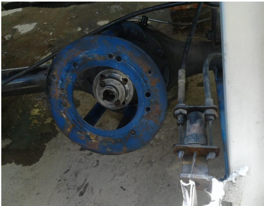
Fig. A2. Adaptador del eje del motor al diferencial
