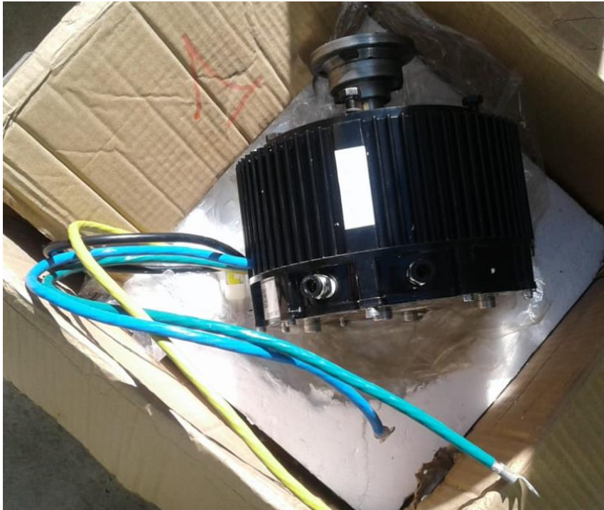
Figura 76. Motor de 5KW con adaptador
