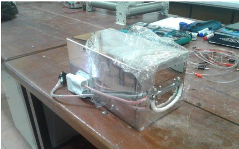
Fig. A8. Batería LiFePO4 de 48V y 20Ah.
