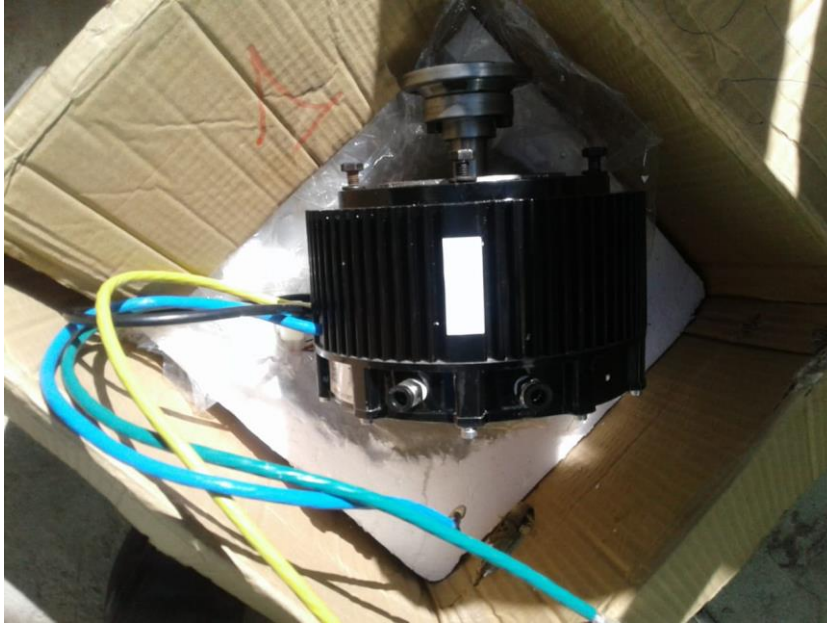
Fig. A1. Motor BLDC de 5KW.
