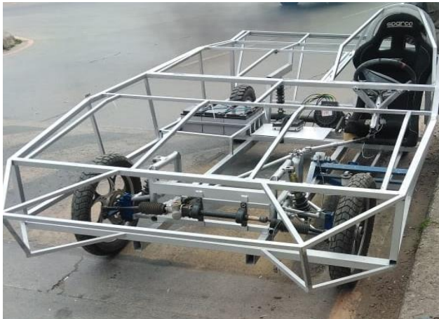
Figura 67. estructura del auto eléctrico
