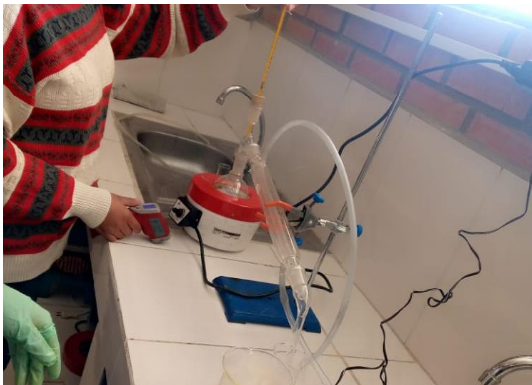
Ilustración 10: Separación y recuperación del etanol
