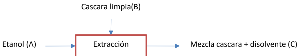
Ilustración 12: Proceso de extracción
