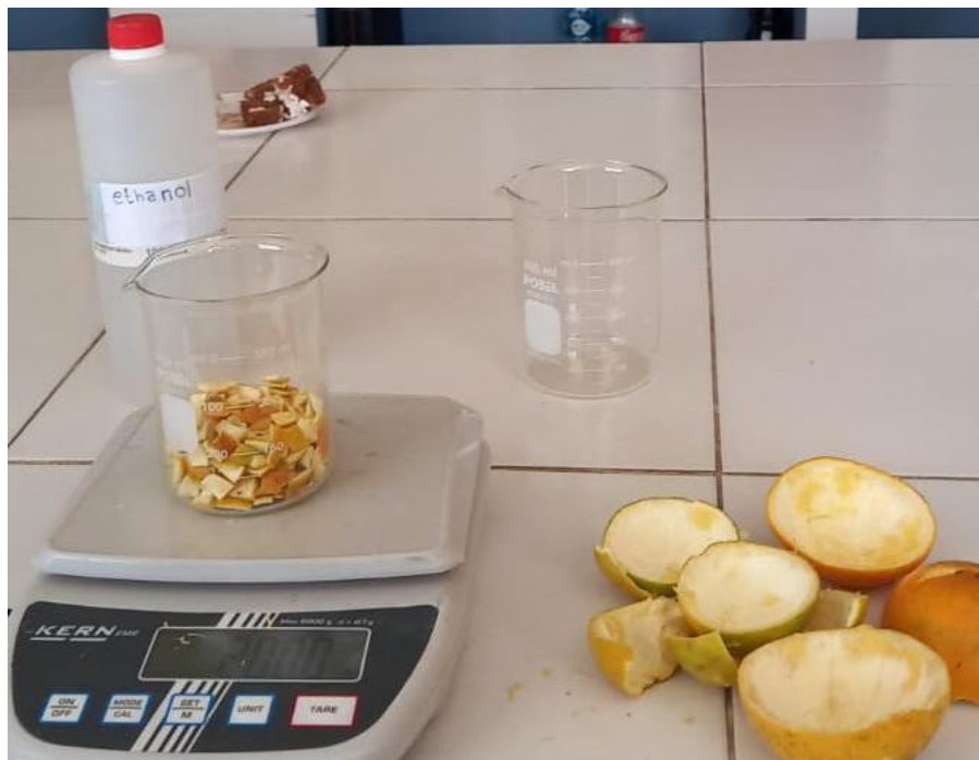
Ilustración 8: Mezclado con disolvente etanol
