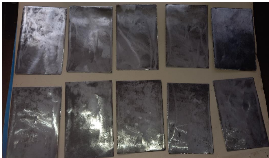
Ilustración 16: Probetas con los inhibidores de oxidación
