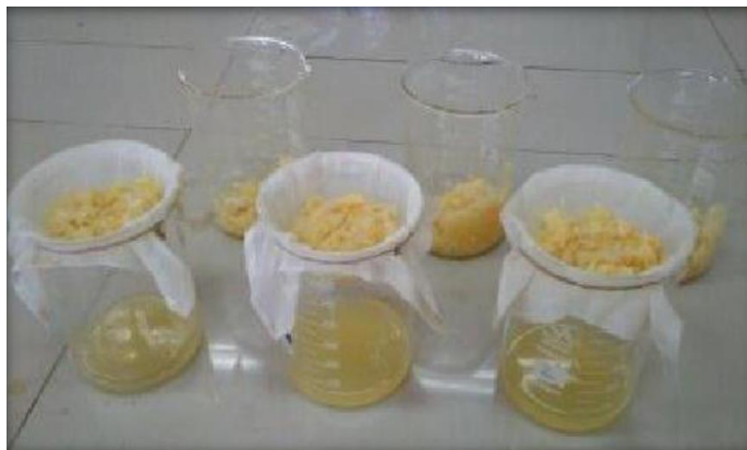
Ilustración 9: Filtrado de la disolución
