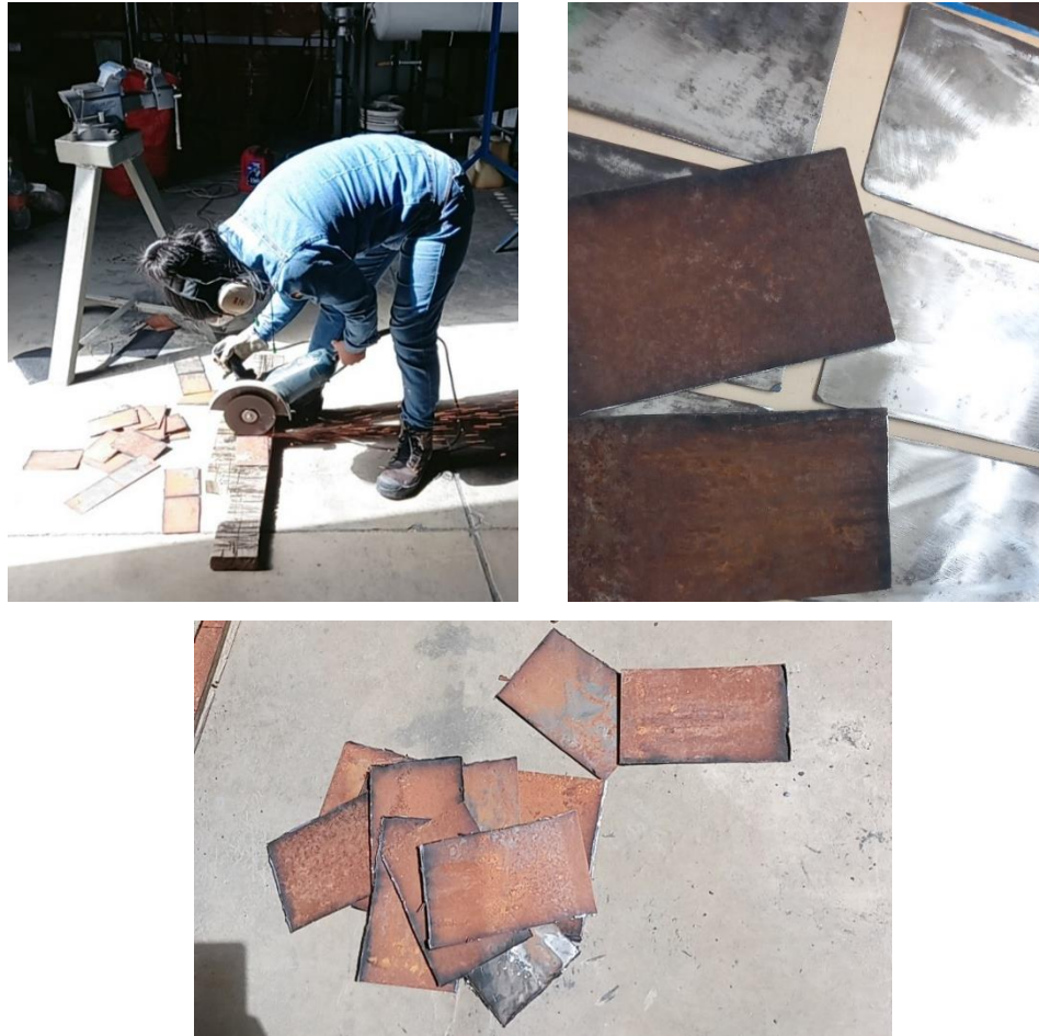
Ilustración 15: Elaboración de las probetas
