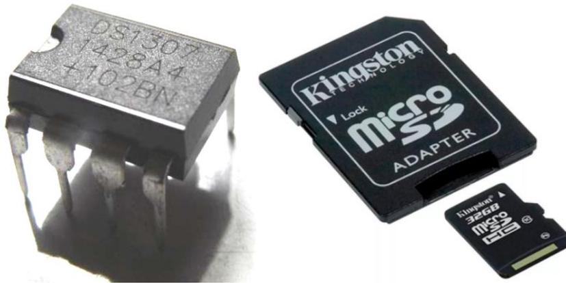
Fuente: Imagen Propio, 2022 (Izquierda RTC DS1307, Derecha Tarjeta SD y su adaptador)
