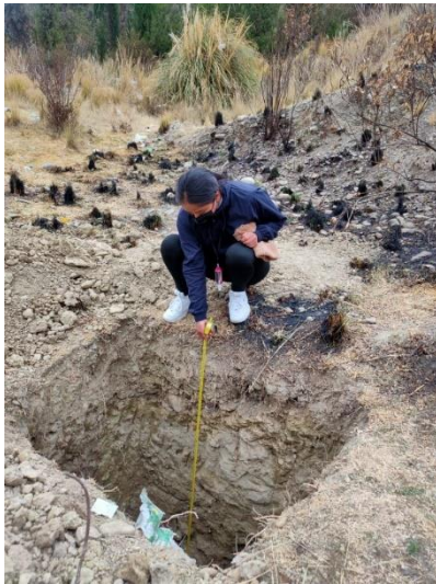
Figura 39. Excavación a cielo abierto pozo 2
