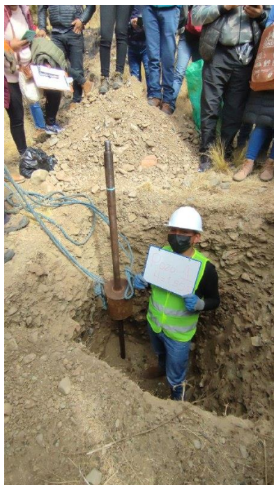
Figura 48. In-situ ensayo SPT pozo 1
