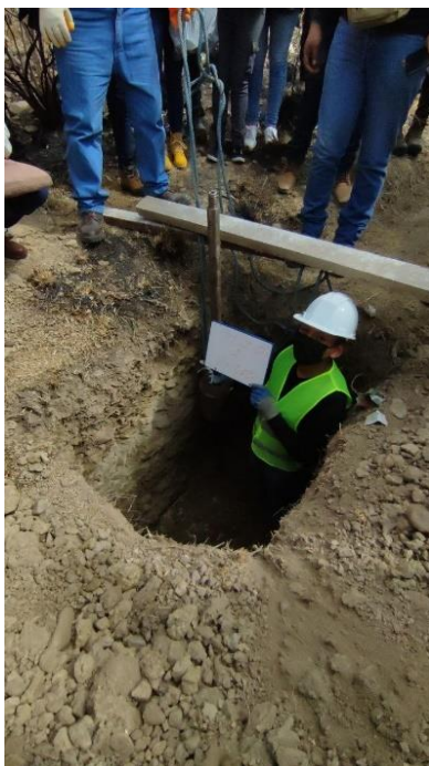
Figura 49. In-situ ensayo SPT pozo 2
