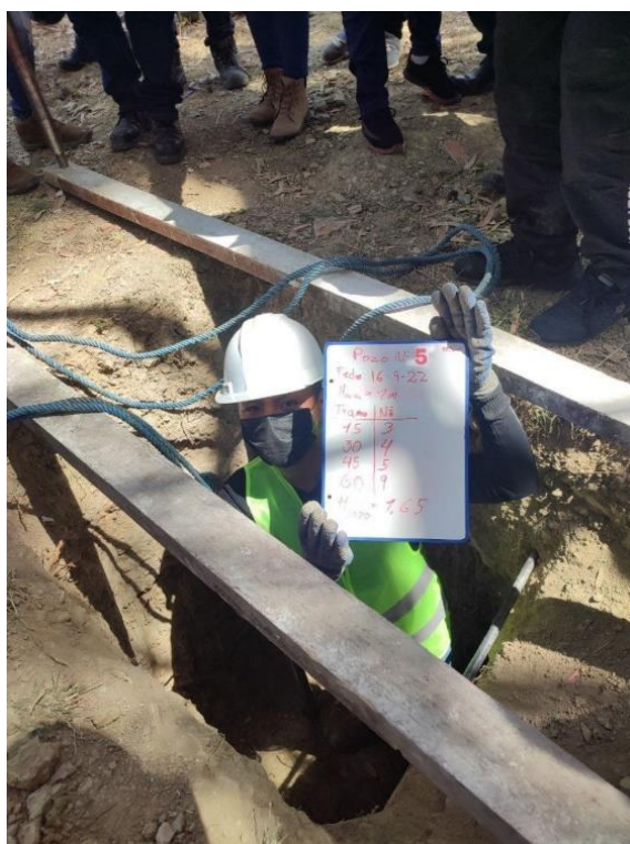
Figura 52. In-situ ensayo SPT pozo 5
