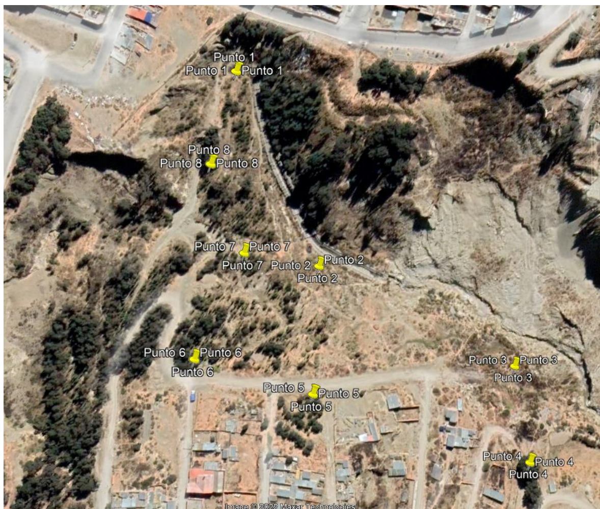
Figura 29. Ubicación de pozos de sondeo para excavación
