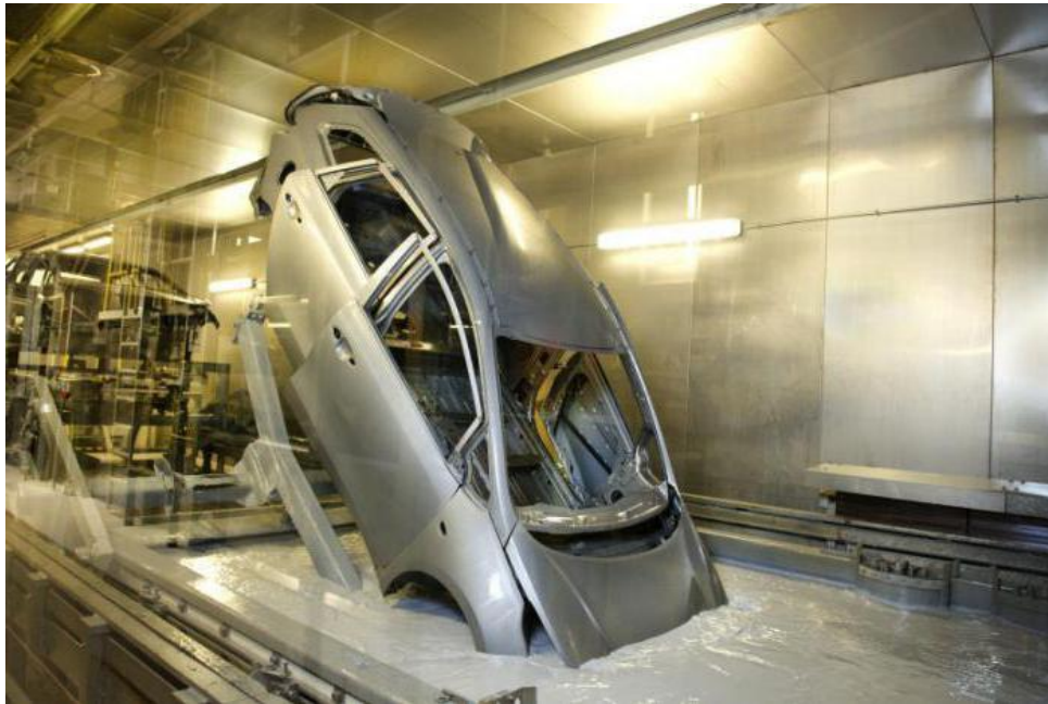
Fig. 7. Inmersión de carrocería en la cuba de cataforesis.
