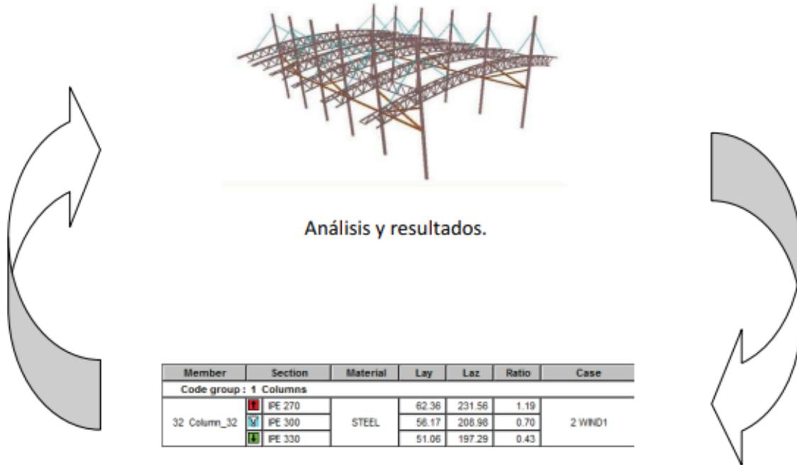
Selección de la sección de diseño y reemplazo en la estructura original.
